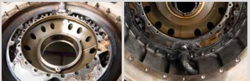
**LIMPEZA SUPERIOR:** A caixa de mancal à esquerda é de um motor CFM56 que usava ASTO 560. É visivelmente mais limpa que a caixa de mancal à direita, que operava com o óleo concorrente por um número similar de horas.
